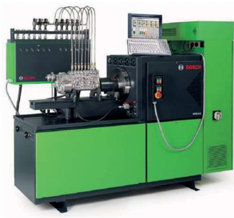
Стенд для діагностики дизельних паливних систем EPS 815
